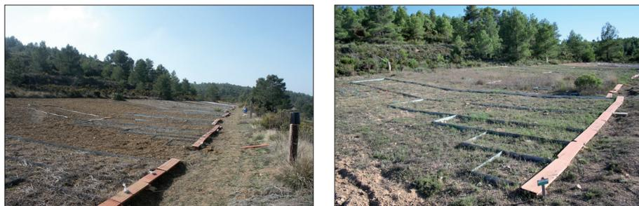
Figura 1. Vista de las 83 parcelas de erosión monitorizadas en la estación experimental de El Teularet-Sierra de Enguera, Valencia. Allí se han cuantificado durante más de una década las pérdidas de suelo bajo distintos manejos, y en distintas áreas (1, 2, 4, 16, 48 m<sup>2</sup>) para conocer el efecto de la escala sobre la pérdida de agua y suelo.
